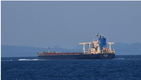
豊後水道で大分に向かう大型鉱石運搬船 NSU プライドと交差しました。25 万 DWT で、異様に煙突が大きい船でした。
